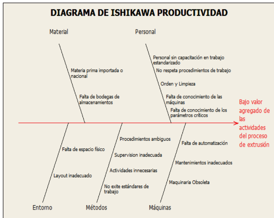
Figura 3.26. Diagrama de Ishikawa del efecto tiempo de ciclo extendido con el uso del software MINITAB 16
