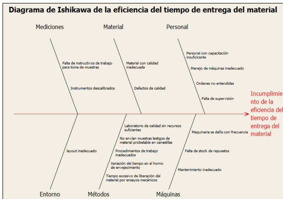
Figura 3.33. Diagrama de Ishikawa del efecto incumplimiento de la eficiencia del tiempo de entrega de material con el uso del software MINITAB 16
