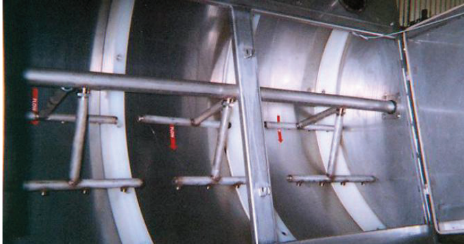
Figura 3.5. Sistema de limpieza por aspersión
