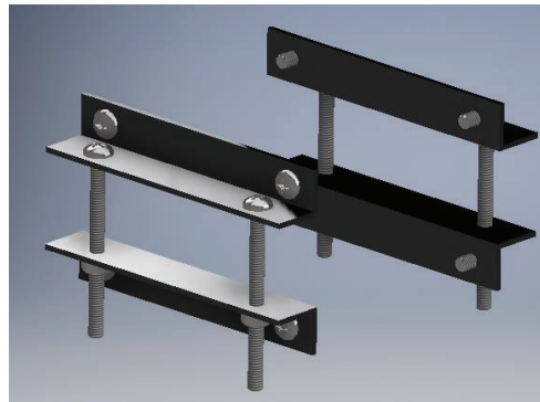
Figura 3.5 Esquema del aparato sujetador del módulo Peltier
