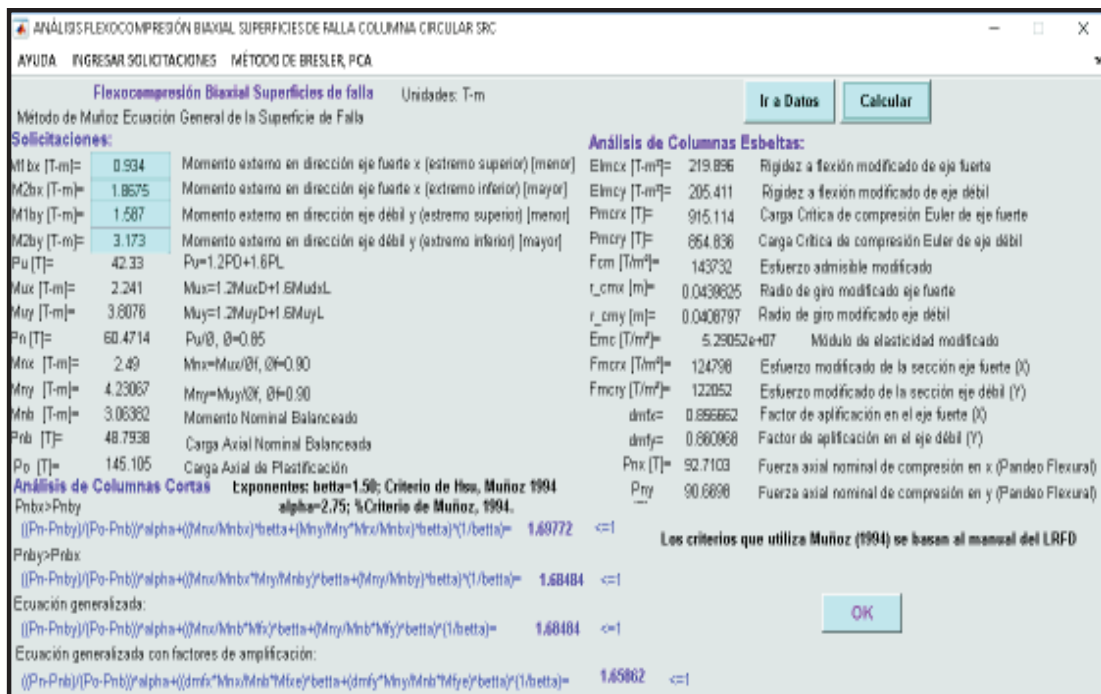
GRÁFICO 3.19 FLEXOCOMPRESIÓN BIAIXIAL Y ANÁLISIS DE LA SUPERFICIE DE FALLA POR EL MÉTODO DE MUÑOZ (1994)
