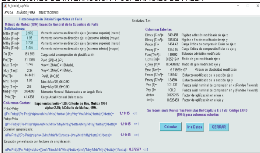
GRÁFICO 3.12 MÉTODO DE MUÑOZ (1994) PARA ANÁLISIS DE LAS ECUACIONES DE INTERACCIÓN Y SUPERFICIES DE FALLA
