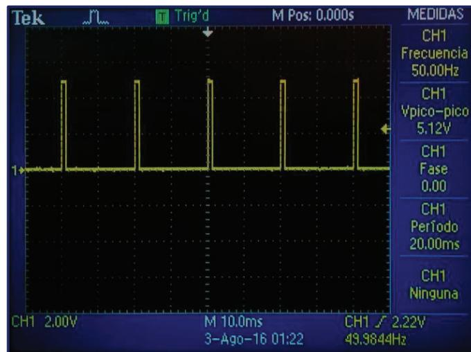
Figura 4.9. Pruebas de la señal de control para un ángulo de 90 grados.
