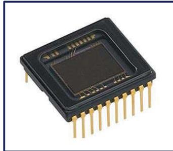
**Figura 1.3.** Sensor óptico de una cámara de video [3]
