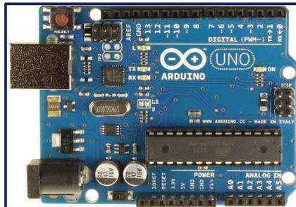
**Figura 1.31.** Placa Arduino Uno. [27]
