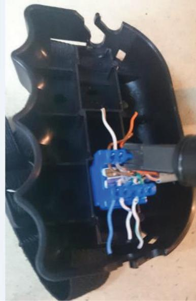
**Figura 63 - Crimpado en conector Jack hembra**
