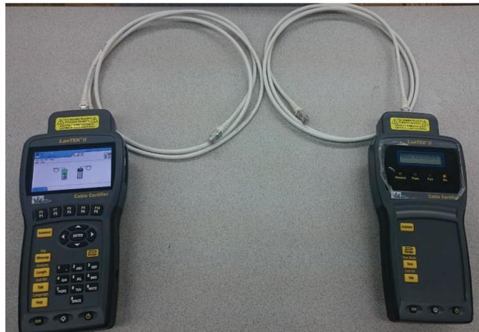
**Figura 71 - Terminal portátil con pantalla (DH) y Terminal remoto (RH)**
