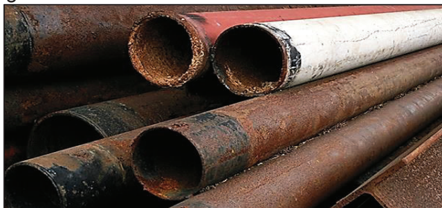
Figura 1- 6 CORROSIÓN QUÍMICA EN TUBERÍAS
