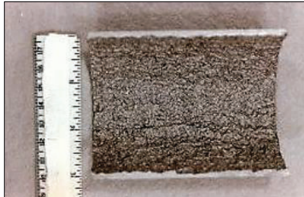
Figura 1- 11 CORROSIÓN UNIFORME PRODUCIDA POR DIÓXIDO DE CARBONO EN LA TUBERÍA DE PRODUCCIÓN
