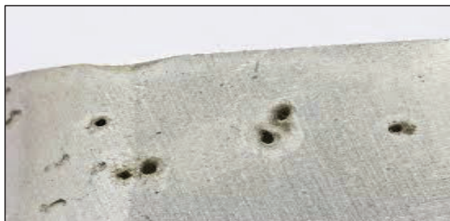
Figura 1- 15 CORROSIÓN LOCALIZADA EN LA TUBERÍA DE PRODUCCIÓN
