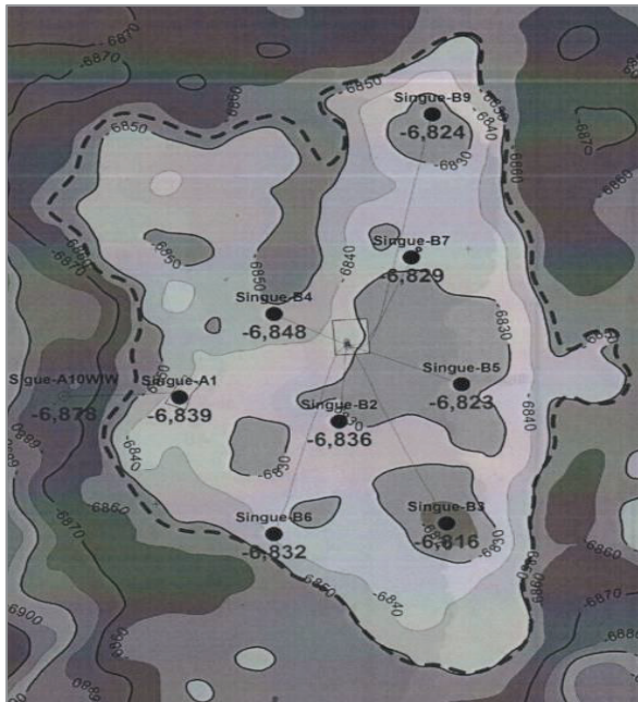
Figura 3.3 Mapa estructural en profundidad – Tope U superior ELABORADO POR: Gente Oil Ecuador Pte. Ltd., 2015
