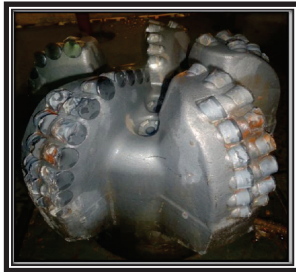
FIGURA 2. 5: DESGASTE AGRESIVO DE BROCA
