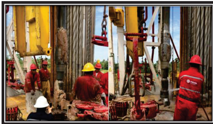
FIGURA 2. 6: EMBOLAMIENTO Y LIMPIEZA DE BROCA
