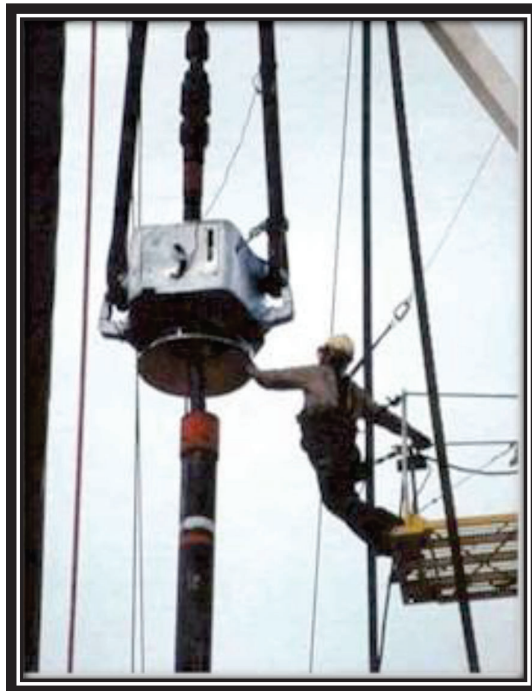
FIGURA 3. 4: CORRIDA DE CASING DE MANERA CONVENCIONAL
