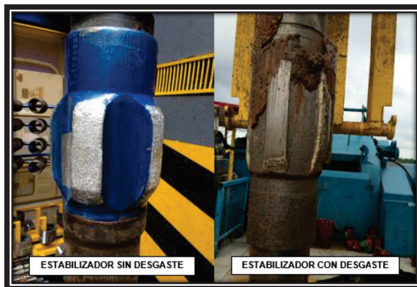
FIGURA 2. 8: DESGASTE AGRESIVO DE ESTABILIZADORES
