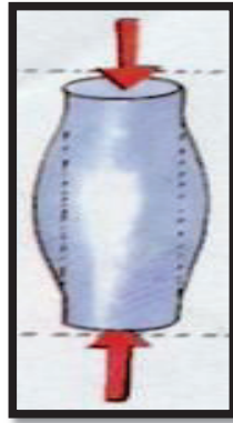
Figura 2-27.- Cilindro soportando esfuerzos de compresión.
