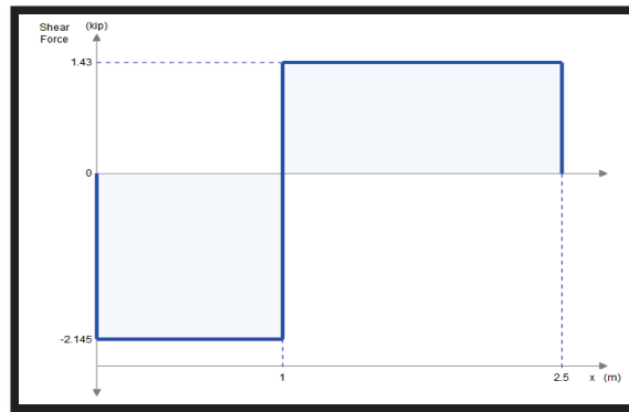
Figura 3-5.- Diagrama de esfuerzo cortante para la viga de carga.
