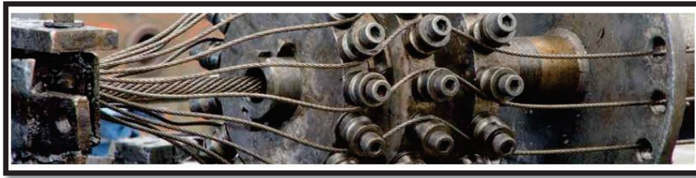
Figura 2-21.- Proceso de fabricación de un cable con alma de acero.
