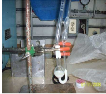
Figura 2.5 Determinación de la viscosidad de las 9 formulaciones
