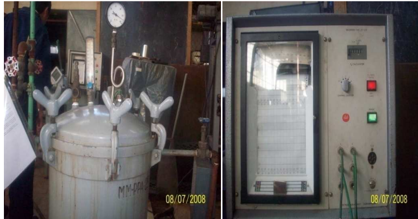
Figura 2.14 Autoclave y registrador de temperatura utilizado en el proceso de esterilización
