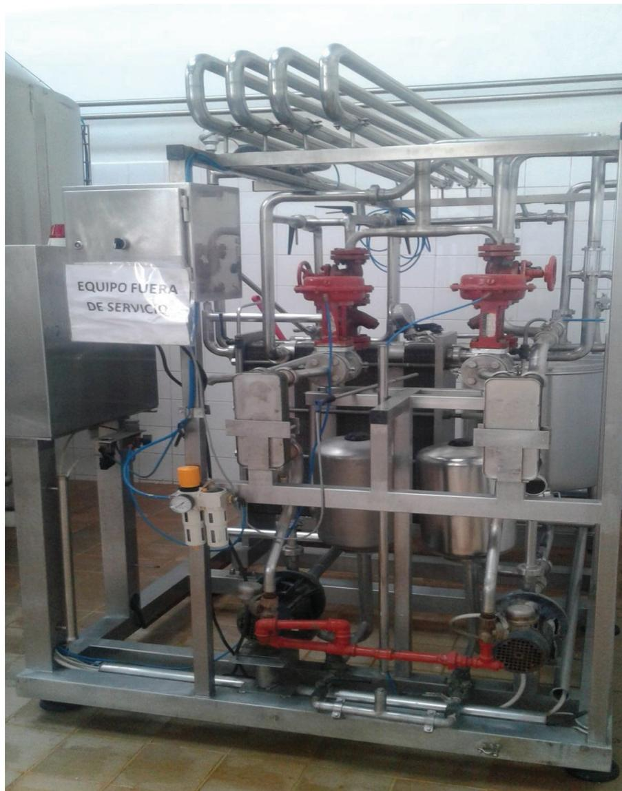
**Figura 1.1.** Pasteurizador Reda, capacidad de 3000L/h
