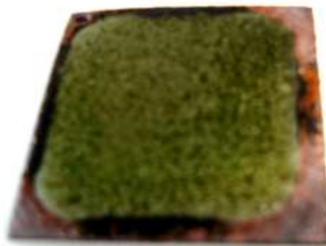
Figura 16: Foto de placas esmaltadas con EMg-1 y Ciclo de cocción 4
