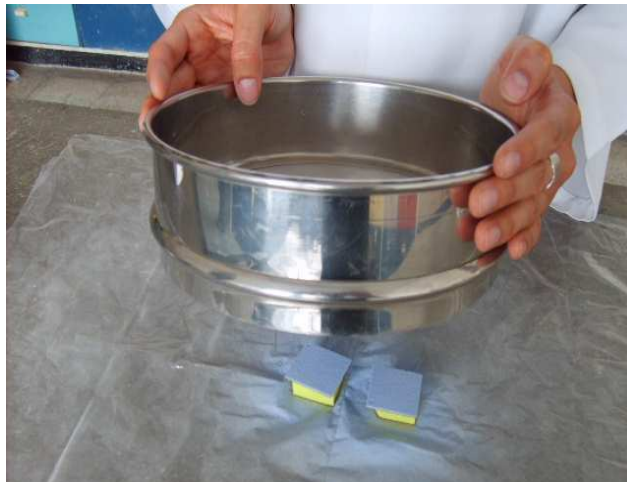
Figura 10: Foto de aplicación de esmalte porcelánico por método de espolvoreo.
