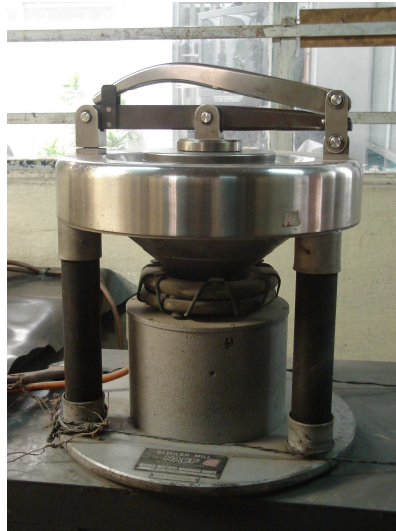
Figura 8: Foto de un Molino pulverizador.
