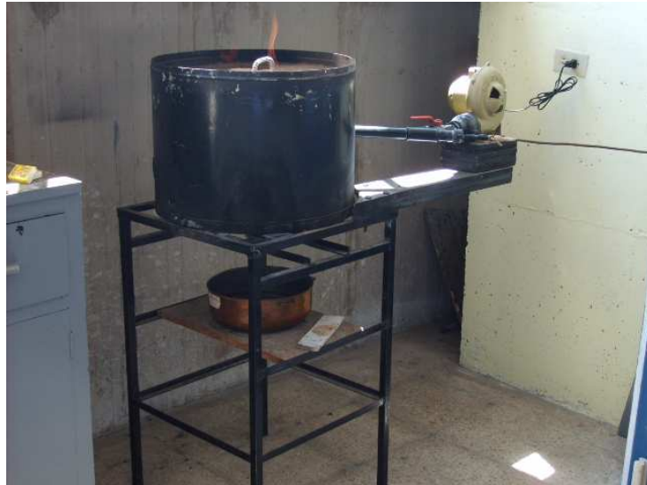
Figura 7: Foto de un Horno de atronado.
