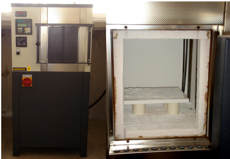
Figura 12: Foto del horno programable. Tablero de control (izquierda), cámara (derecha).
