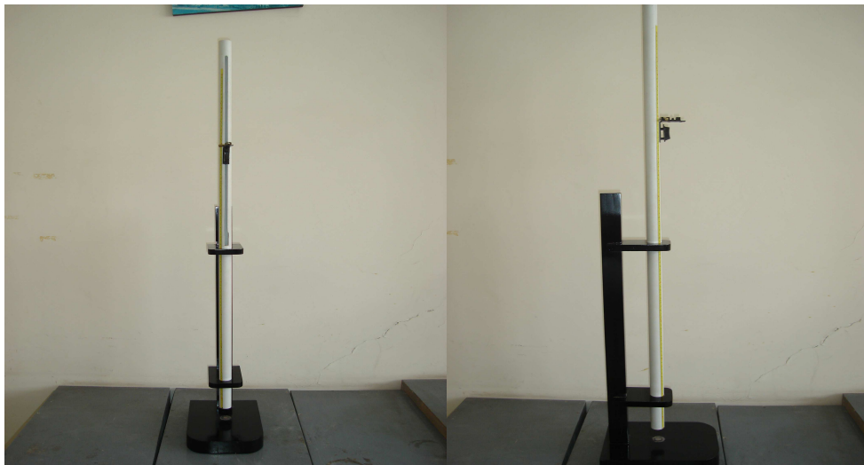
Figura 19: Foto del equipo para pruebas de resistencia al impacto.
