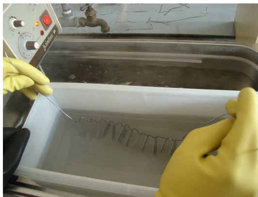
Figura 9: Foto de baño alcalino en recipiente de polipropileno termostatzado.
