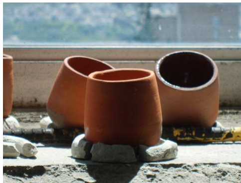
Figura 6: Foto de crisoles cerámicos para atronar vidrio.
