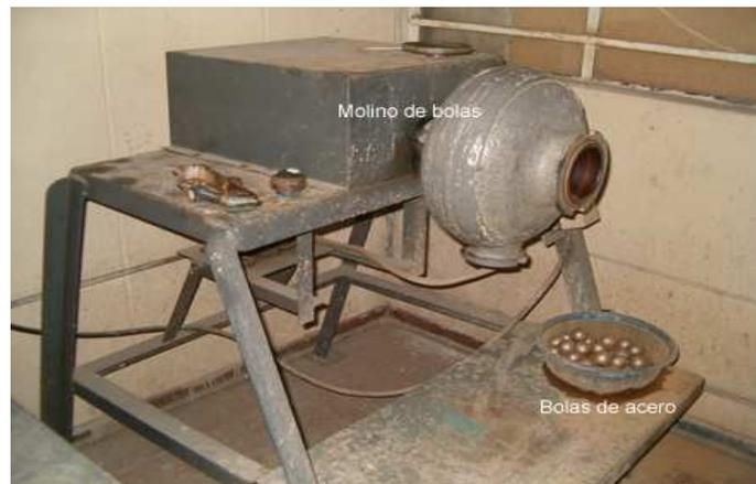
**Figura 9:** Molino de bolas utilizado para el ensayo en el laboratorio.
