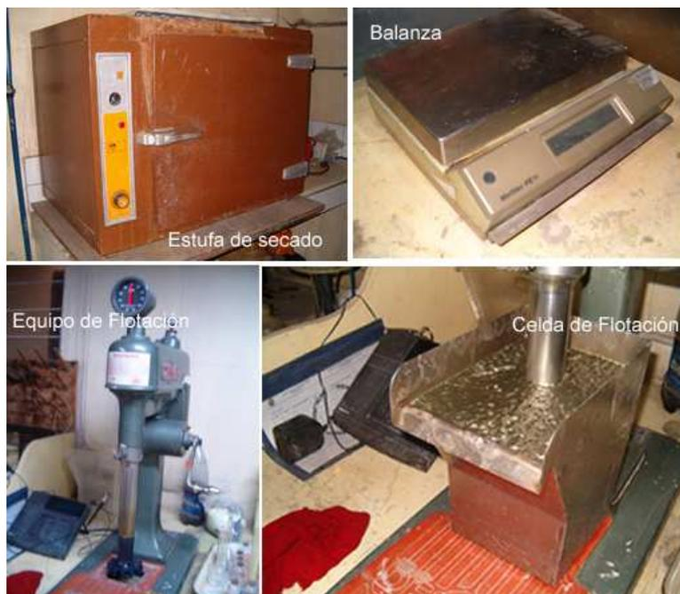
**Figura 11:** Equipos Utilizados en los ensayos del laboratorio.
