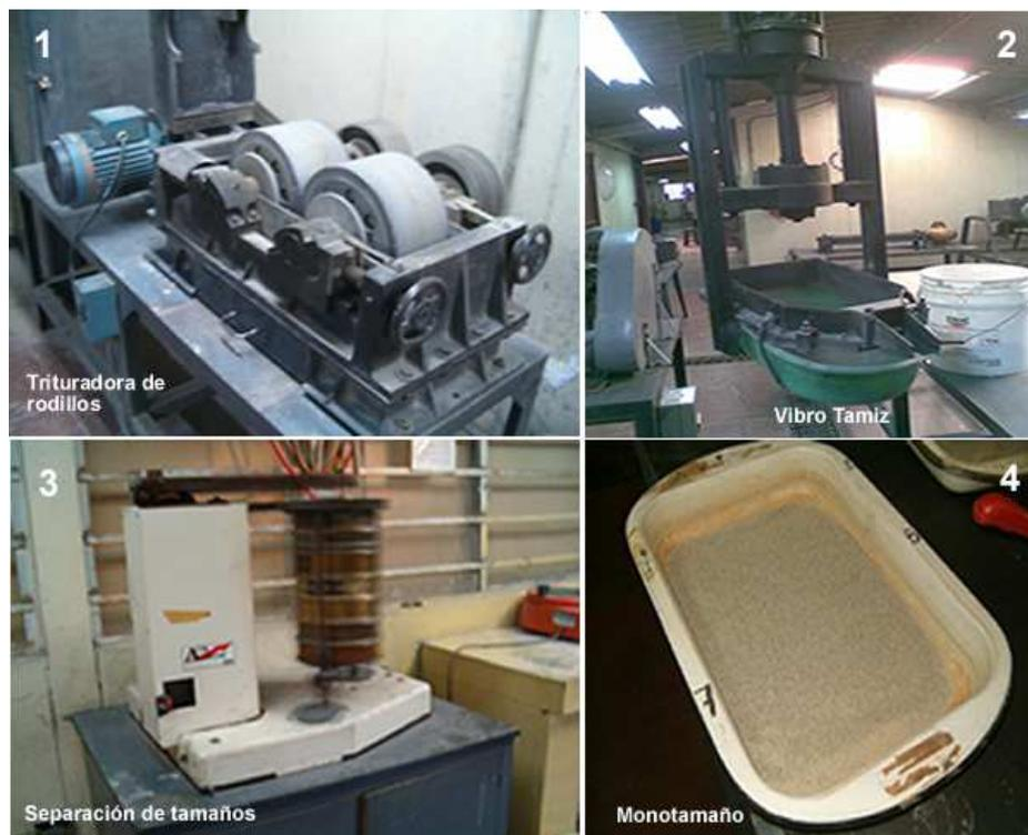
**Figura 12:** Equipos utilizados para la obtención de monotamaños
