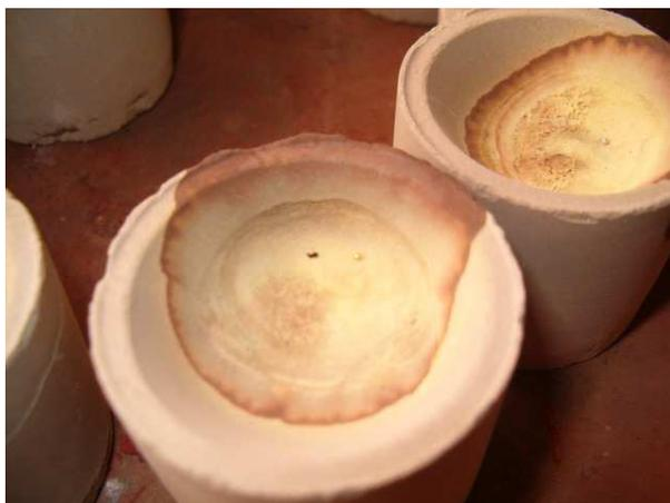
**Figura 13:** Doré obtenido después de los ensayos al fuego.
