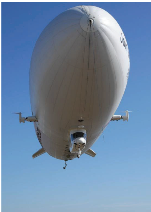
Figura 1.4 Fotografía de un dirigible con su sistema de propulsión, un motor ubicado a cada lado del envoltente.
