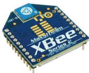
Figura 2.21 Módulo de comunicación XBEE.
