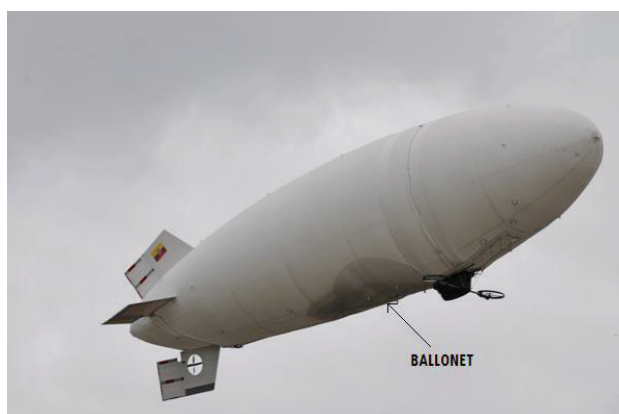
Figura 1.1 Dirigible no rígido de 9 m de longitud, sustentado con helio y en su interior se muestra el ballonet desinflado.
