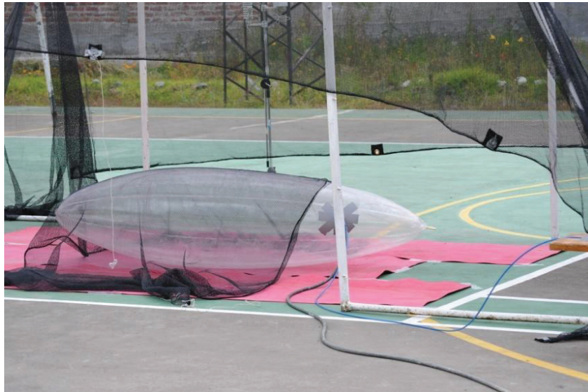
Figura 4.1 Probeta de 3 metros utilizada en pruebas destructivas.
