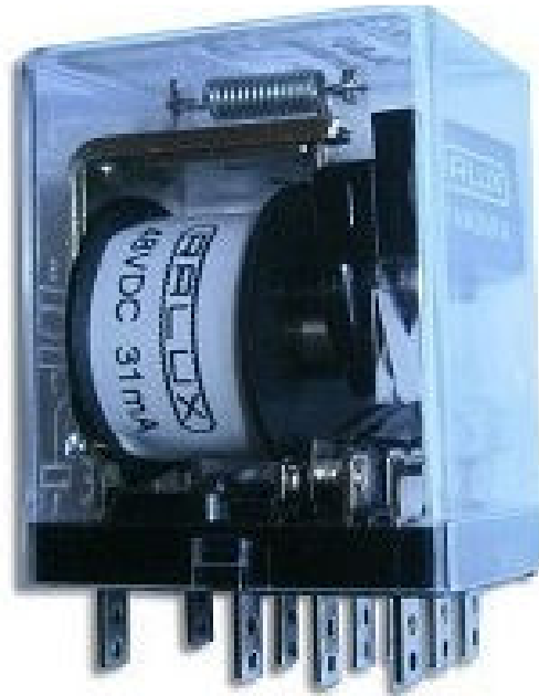
Figura 2.15 Relé 110V marca RALUX
