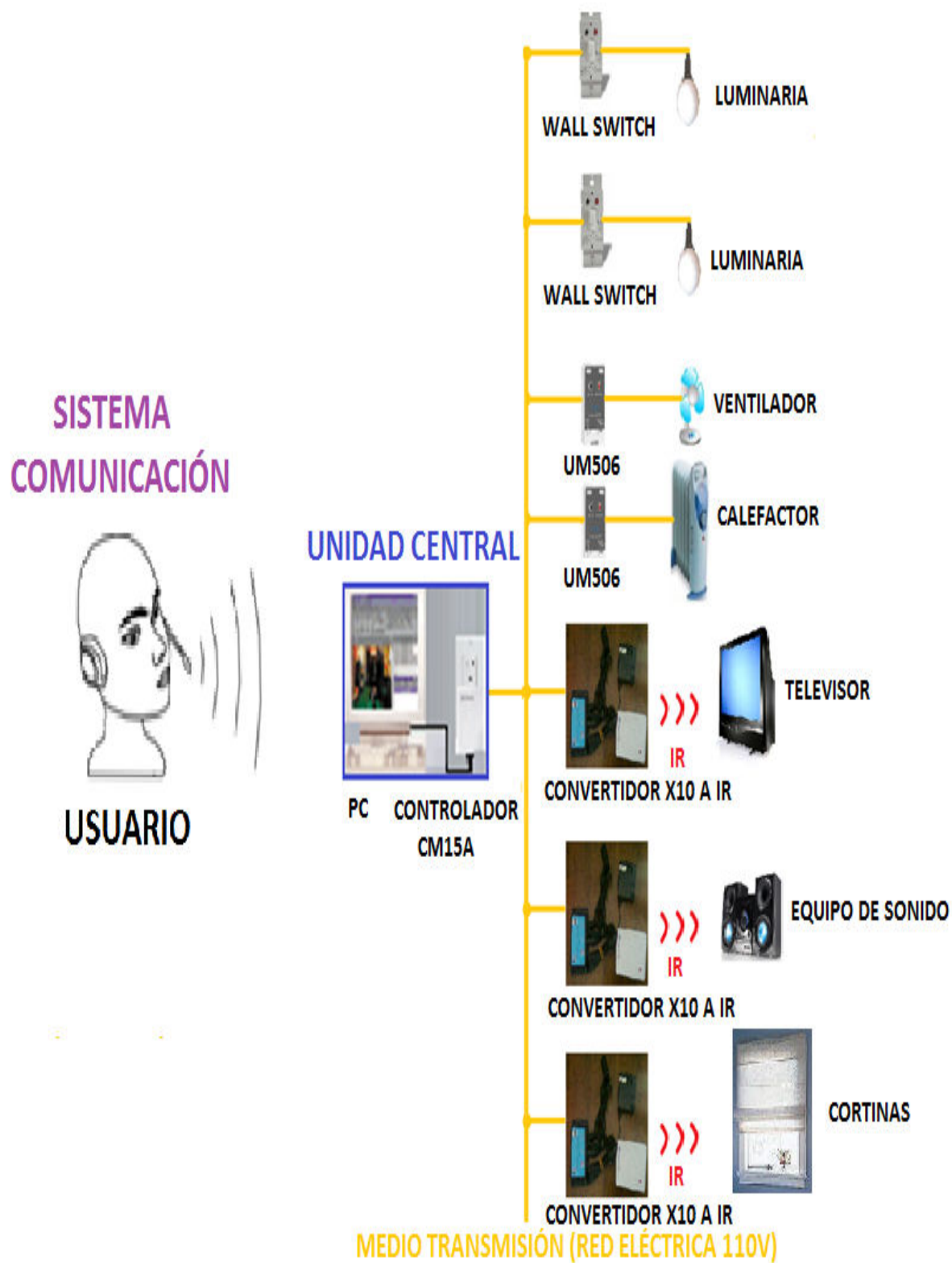
Figura 2.33 Módulos que conforman el sistema propuesto
