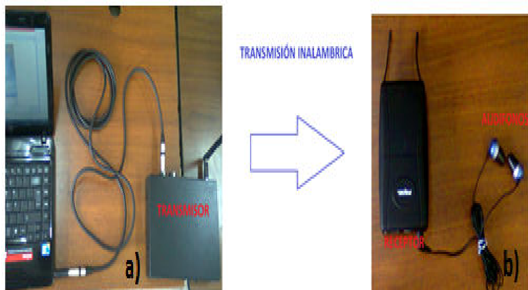
Ilustración 9. Conexión del sistema de recepción.
