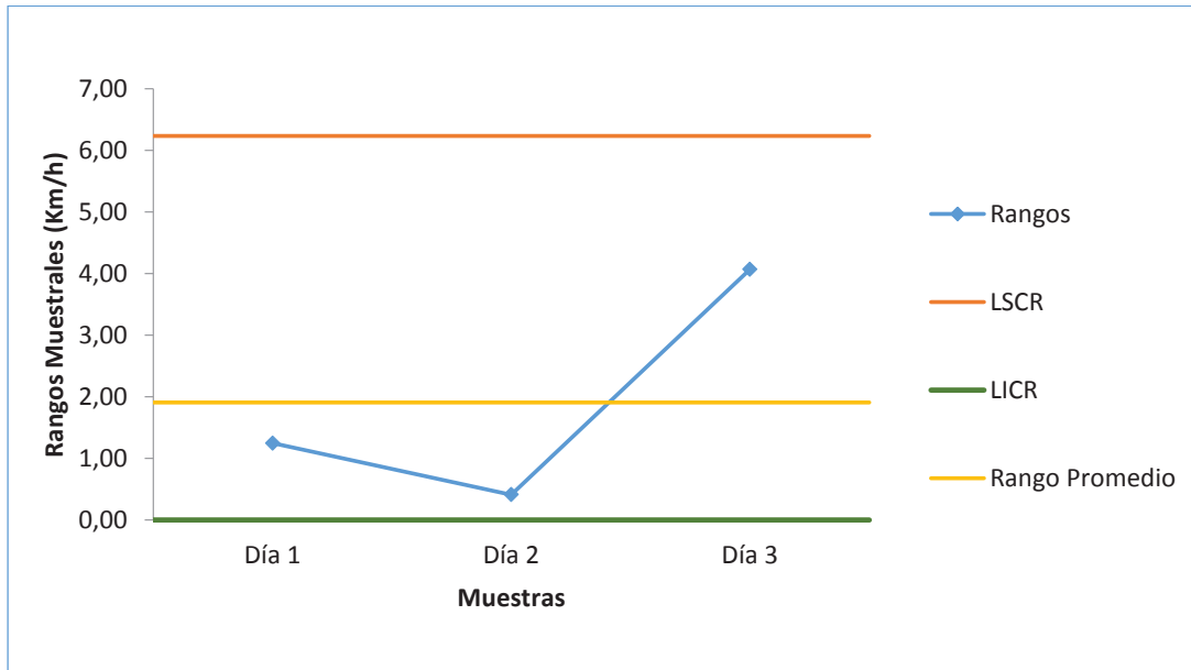
Figura 4.11. Gráfica de control para rangos muestrales de velocidad promedio-Ciclo ciudad (Fuente: Propia)
