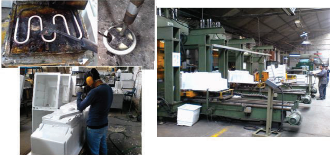
Figura 3.3. Perforación de tanques y piezas plásticas (a) Proceso en caliente. (b) Proceso en frío (Fuente: Fotografías ECASA, 2016)
