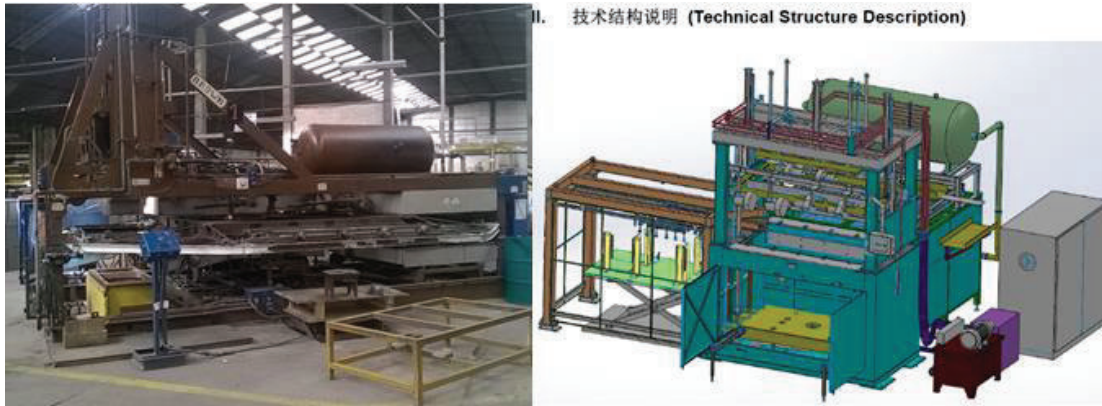
Figura 3.5. Reemplazo de Termoformadoras Brown (a) por una simple estación de King Power (b) (Fuente: Fotografías ECASA, 2016)
