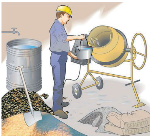
Figura 2.22: Mezcla del Hormigón
