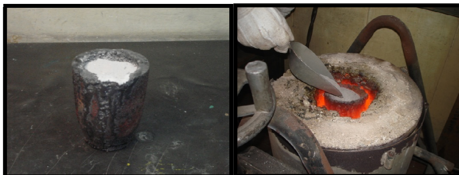
Figura 2.9: Crisol de grafito y de un horno tipo a gas
