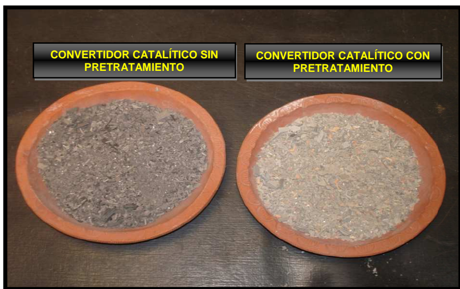
Figura 2.7: Convertidor catalítico sin pretratamiento y con pretratamiento.
