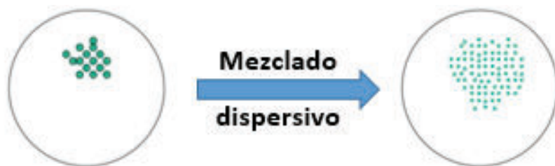
Figura 1.14. Representación de tipo de mezclado dispersivo (Beltrán Rico y Marcilla Gomis, 2012, p. 81)
