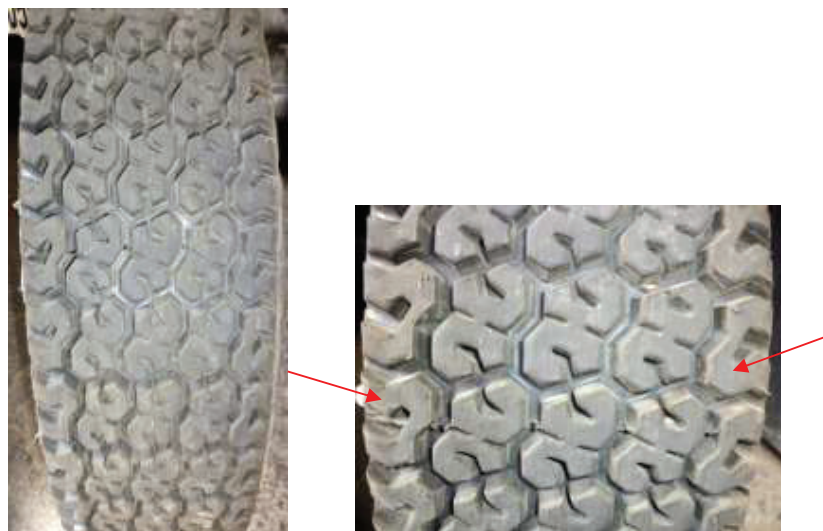
Figura 4.45 Desgaste del neumático reencauchado en frío.
