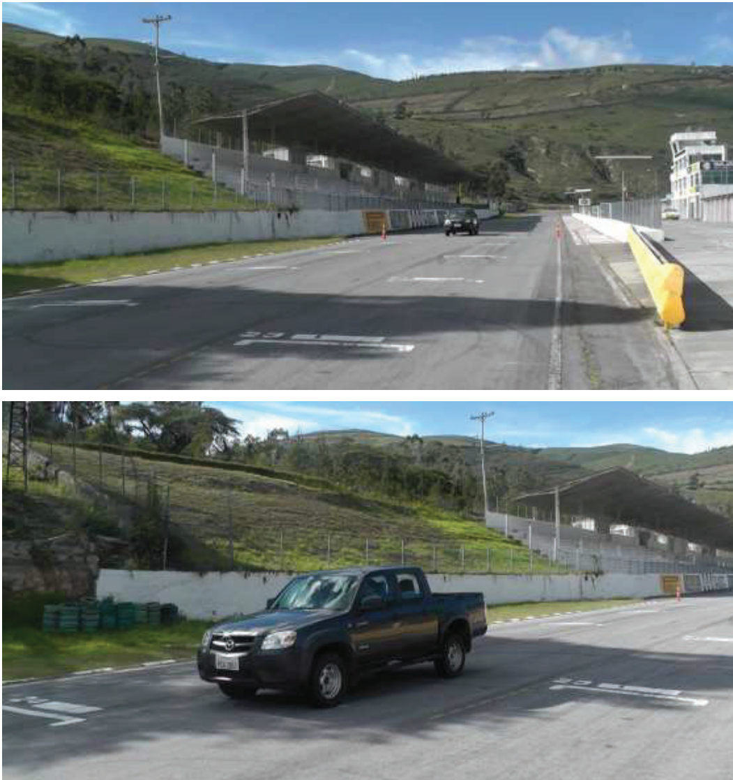
Figura 4.24 Medición de la distancia de frenado.
