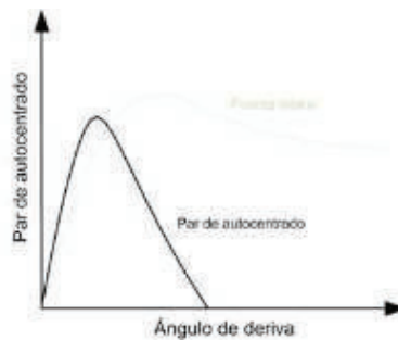
Figura 2.11 Relación entre el momento autoalineante y el ángulo de deriva.
