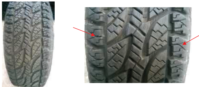
Figura 4.47 Desgaste del neumático reencauchado en caliente.
