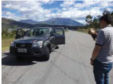
Figura 3.13 Medición de la temperatura de los neumáticos. (Fuente: Autores)
