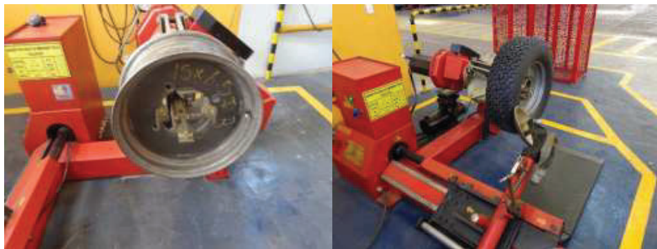
Enllantaje de neumáticos en aros especiales para pruebas en el tambor dinamométrico
