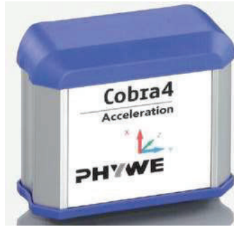
Figura 3.14 Sensor de aceleración 3D cobra.
