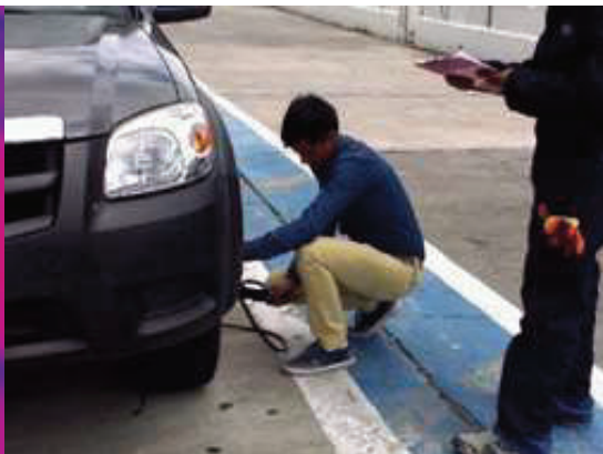
Medición de la temperatura y presión de los neumáticos luego de las pruebas
