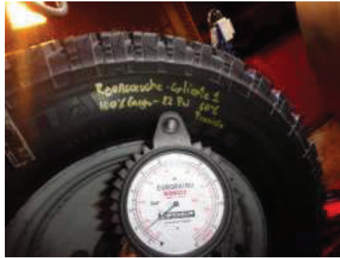
Figura 4.2 Medición de la presión de inflado antes de la prueba.
