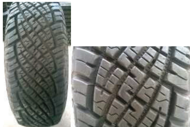
Figura 4.39 Desgaste del neumático marca A.
