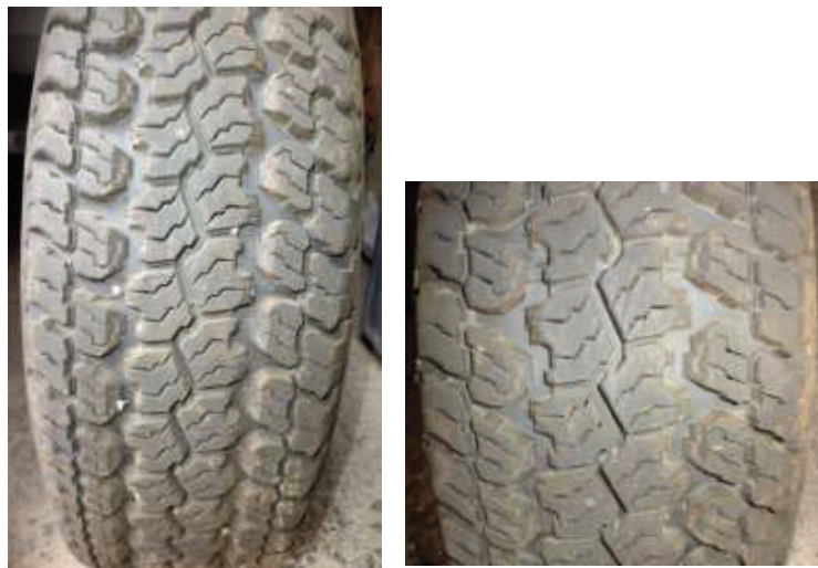
Figura 4.41 Desgaste del neumático marca B.
