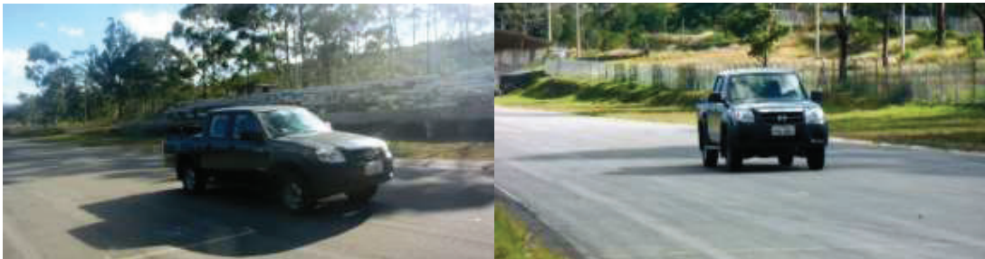
Figura 4.23 Distancia de resistencia a la rodadura Marca C (izq.), Reencauche en caliente (der.)
