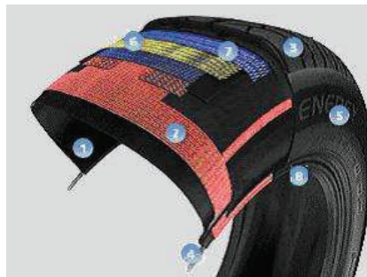
Figura 2.2 Sección transversal de un neumático radial.
