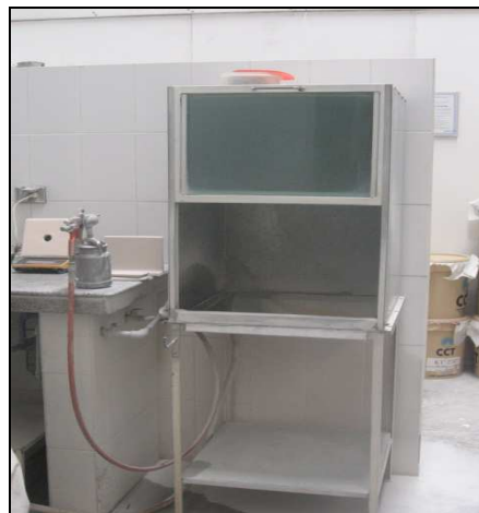
Figura 2.4. Cabina para la aplicación del esmalte a nivel laboratorio
