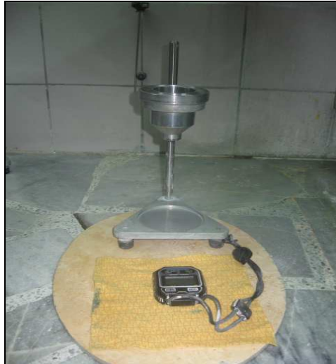
Figura 2.18. Copa FORD utilizada para medir la viscosidad de escurrimiento instantáneo (VEI) en unidad de tiempo.
