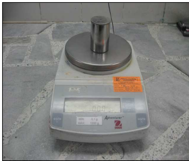
Figura 2.2. Picnómetro y balanza OAUS Adventure utilizados para la medición de la densidad del esmalte
