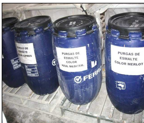
Figura 2.11. Recipientes implementados para la recolección de esmalte contaminado por color proveniente, de las purgas de colores fuertes.
