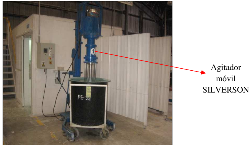
Figura 2.16. Recipiente de 400 litros y agitador utilizado para la preparación del esmalte procedente de las paredes de la cabina.
