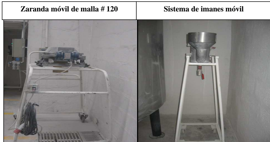
Figura 2.17. Instrumentos utilizados para limpiar el esmalte de hierro e impurezas.
