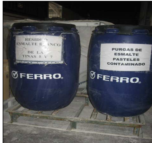
Figura 2.13. Recipiente utilizado para la recolección del esmalte contaminado procedente de las purgas de los colores pasteles.
