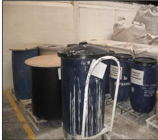
Figura 2.14. Recipiente utilizado para la recolección del esmalte contaminado procedente de la bandeja posterior de las cabinas.
