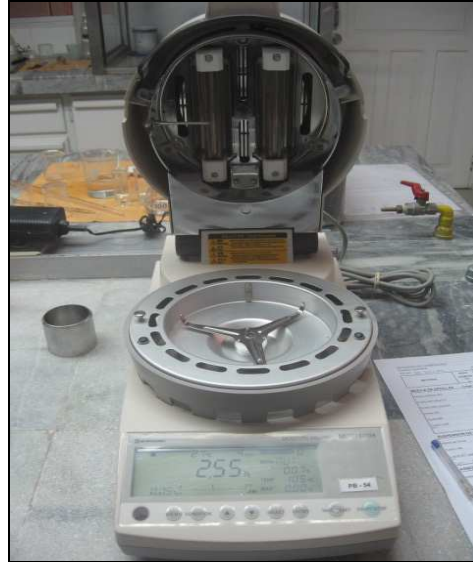
Figura 2.15. Balanza de humedad MOISTURE BALANCE MOC – 120H
