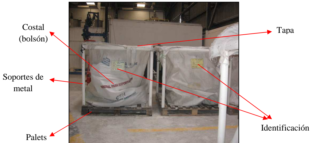
Figura 2.10. Recipientes instalados para la recolección de esmaltes de colores fuertes procedentes de las paredes de la cabina.
