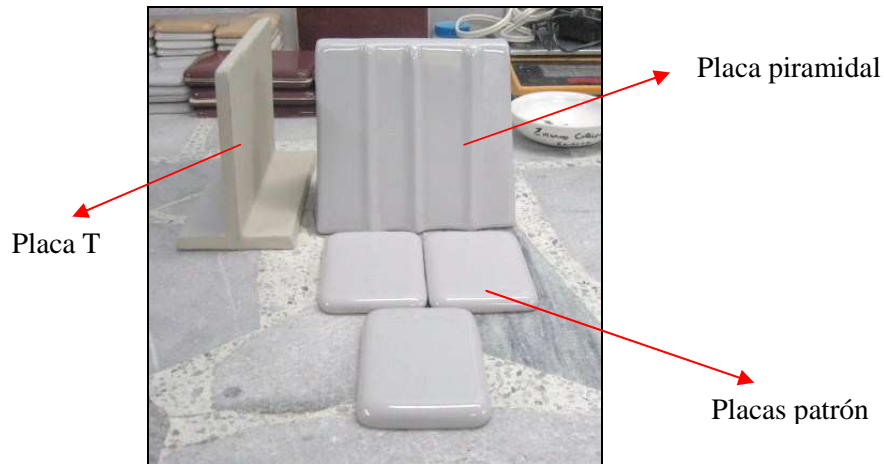
Figura 2.6. Tipos de placas utilizadas para la aprobación de un Bach en colores pasteles
