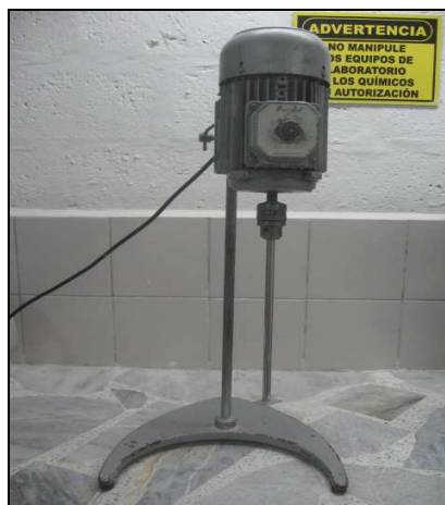
Figura 2.3. Agitador utilizado para mezclar esmalte de pruebas a escala de laboratorio.
