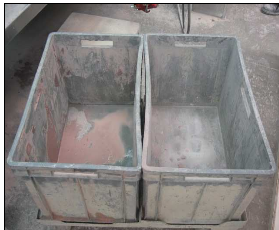
Figura 2.9. Coches utilizados para transportar el esmalte recolectado en colores fuertes de las paredes de la cabina.
