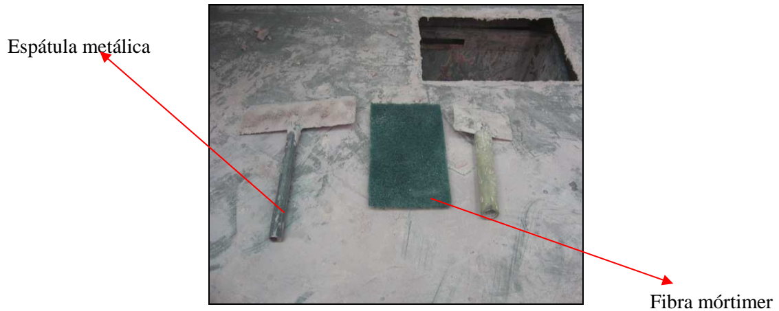
Figura 2.8. Instrumentos de limpieza utilizados para recolectar el esmalte de las paredes de la cabina
