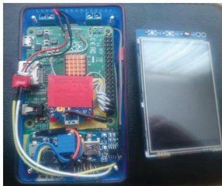
**Figura B.1** Desmontaje del dispositivo audioguía
