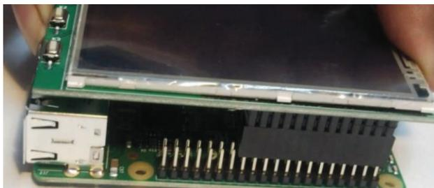
**Figura 2.14** Conexión Física de la LCD TFT a la Raspberry Pi 2
