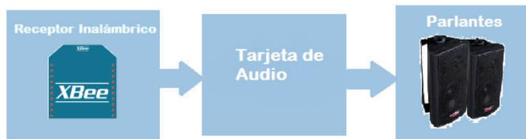
**Figura 2.16** Esquema de entradas y salidas de la tarjeta de audio
