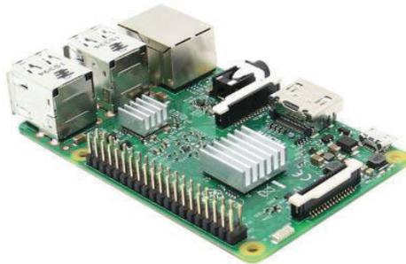
**Figura 2.30** Raspberry Pi 2 con disipadores
