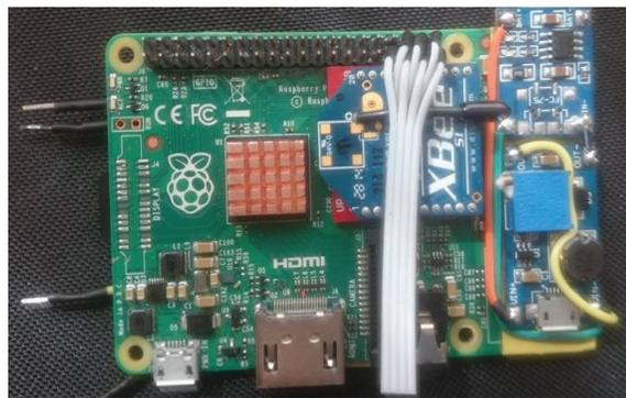
**Figura 2.24** Ubicación del módulo de carga, circuito elevador de voltaje y Xbee
