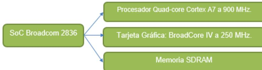
Figura 1.9 Componentes Chip SoC Broadcom 2836
