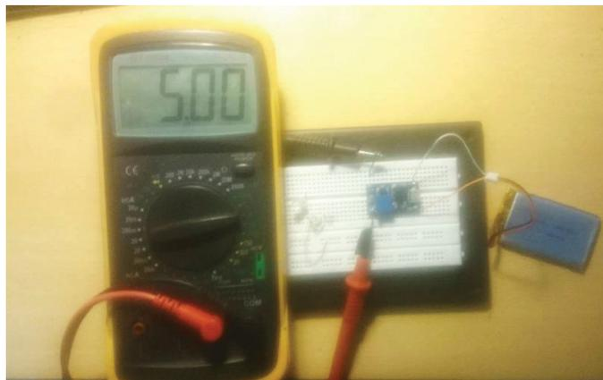
**Figura 2.6** Calibración de salida de voltaje del Circuito Elevador
