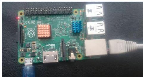
**Figura B.5** Conexión de alimentación y red
