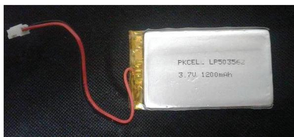
**Figura 2.3** Batería Li-Po PKCEL-LP503562
