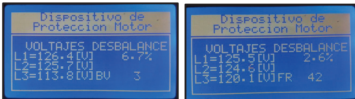
Figura 4.10 Detección de un voltaje fuera de rango y un bajo voltaje. [Elaboración propia]
