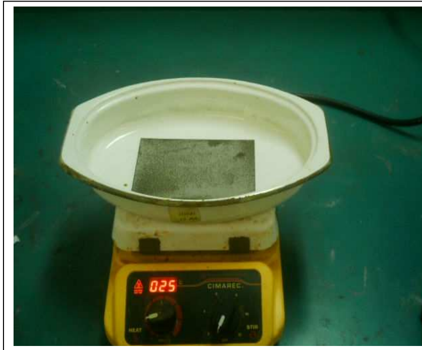
Figura 2.13: Baño químico de limpieza
