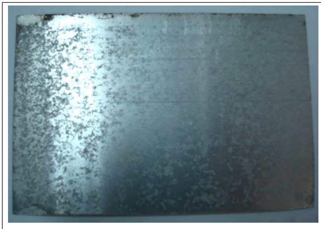
Figura 3.21.- Probeta de aluminio, cara anterior (1 año de exposición). Estación Refinería
