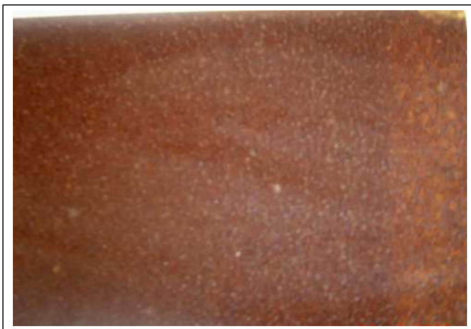
Figura 3.1: Probeta de acero, cara anterior (0.75 año de exposición, Estación ILT)
