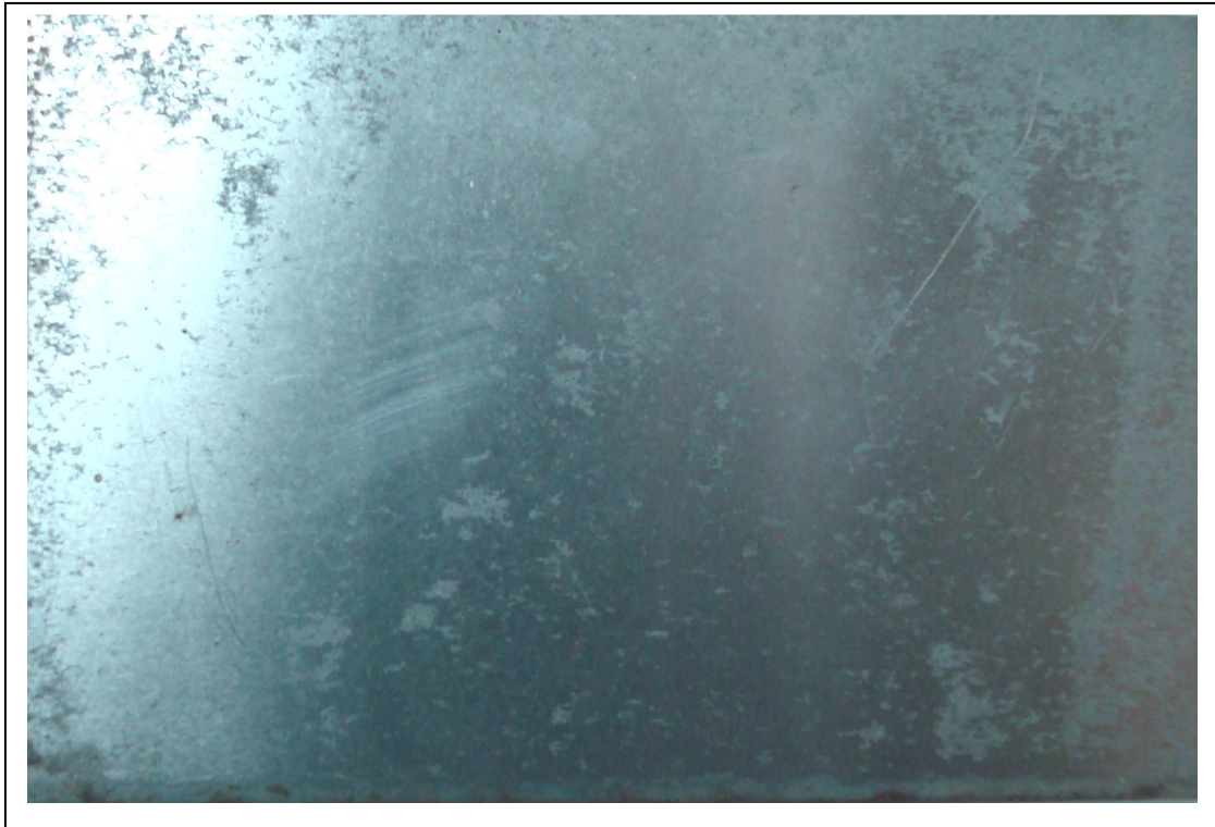
Figura 3.22.- Probeta de aluminio, cara posterior (1 año de exposición) Estación Refinería
