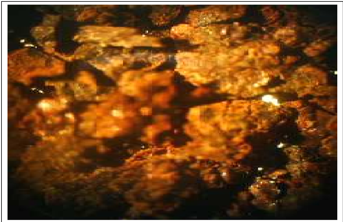
Figura 3.4: Micrografía 40 x, superficie corroída del acero, cara posterior (1 año de exposición, Estación ILT).
