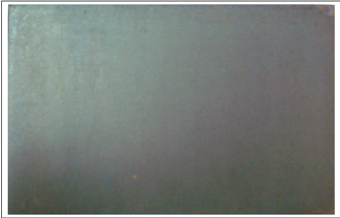
Figura 3.12: Probeta de cobre, cara posterior (1 año de exposición) Estación INOCAR
