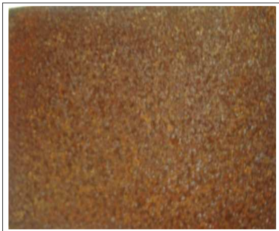
Figura 3.2: Probeta de acero, cara posterior (0.75 año de exposición, Estación ILT).
