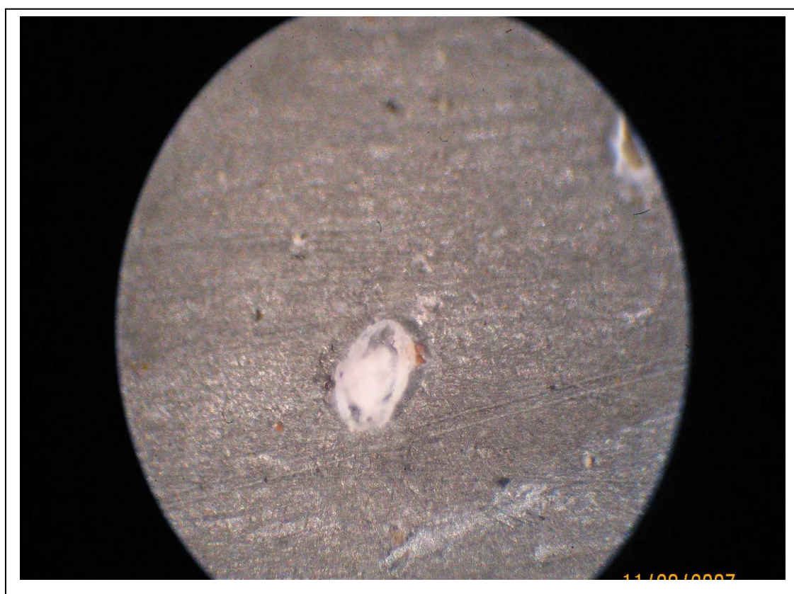
Figura 3.30.- Micrografía 40 x, nido de corrosión del zinc, cara anterior, Estación INOCAR, (1 año de exposición).
