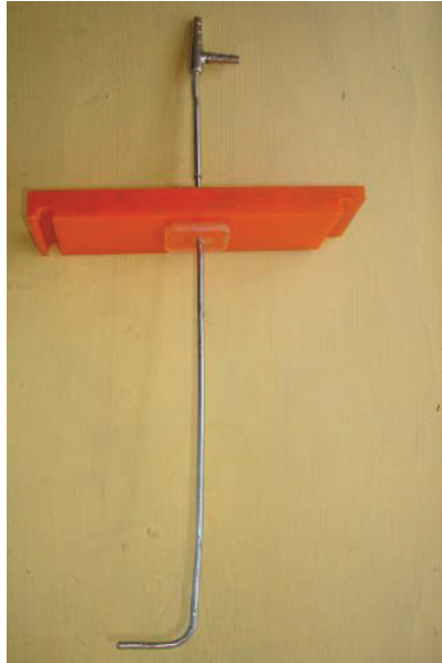
Fotografía No. 5: INSTRUMENTO DE MEDICIÓN DE LA CARGA DE VELOCIDAD (Tubo Prandtl).
