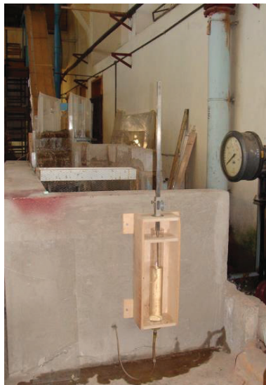
Fotografía No. 4: SISTEMA PIEZOMÉTRICO, PARA LA DETERMINACIÓN DE CAUDALES (EPN-EMAAPQ/2000).
