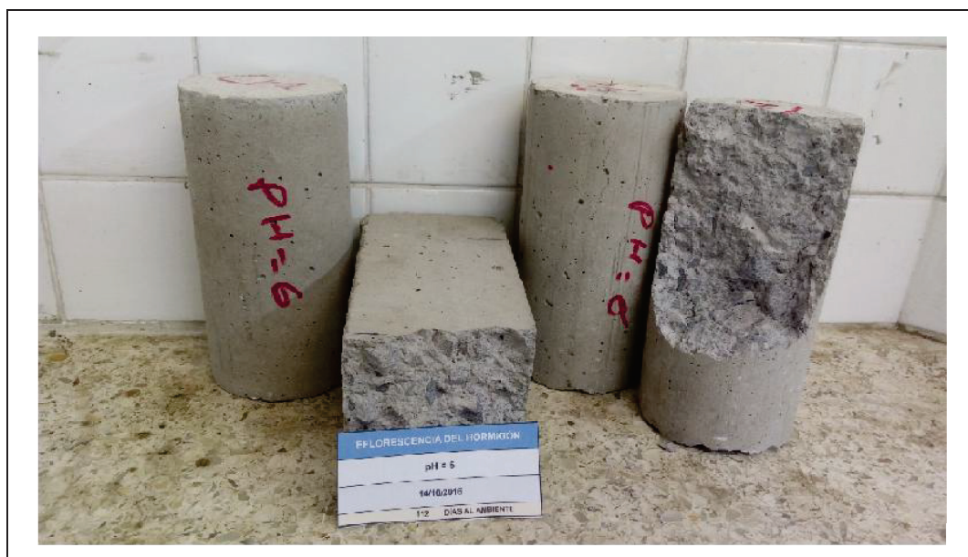
FOTOGRAFÍA 4. 6. MUESTRA: pH = 6 CON 112 DÍAS AL AMBIENTE.
