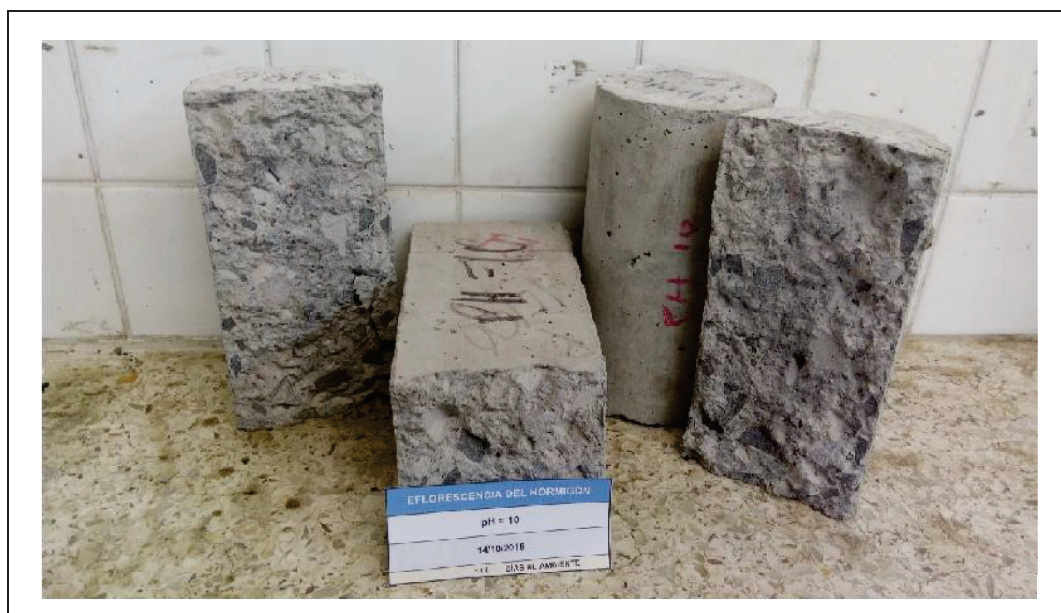
FOTOGRAFÍA 4. 4. MUESTRA: pH = 10 CON 114 DÍAS AL AMBIENTE.
