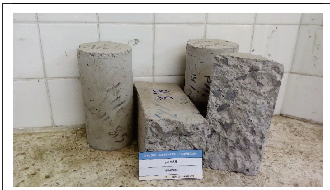
FOTOGRAFÍA 4. 3. MUESTRA: pH = 8,5 CON 115 DÍAS AL AMBIENTE.
