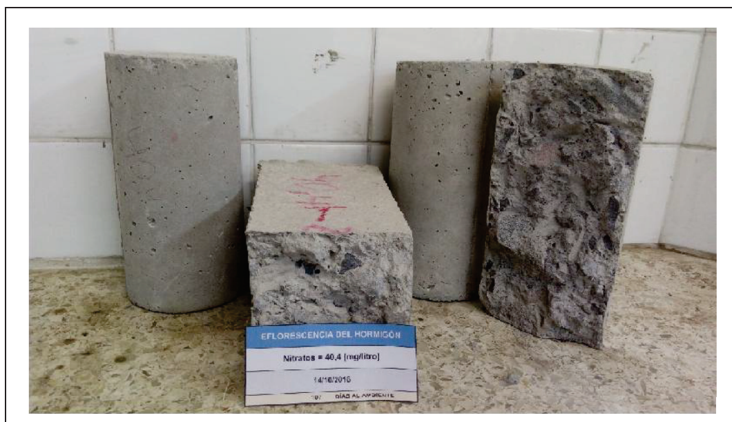
FOTOGRAFÍA 4. 8. MUESTRA: 40,4 [MG/L] CON 107 DÍAS AL AMBIENTE.
