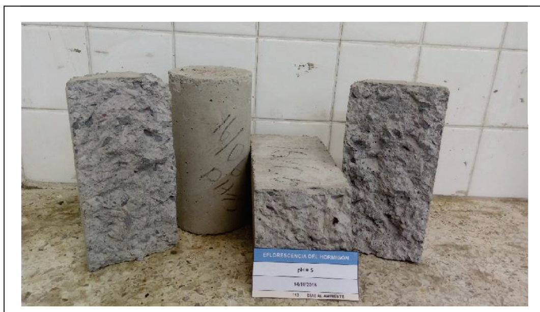
FOTOGRAFÍA 4. 5. MUESTRA: pH = 5 CON 113 DÍAS AL AMBIENTE.
