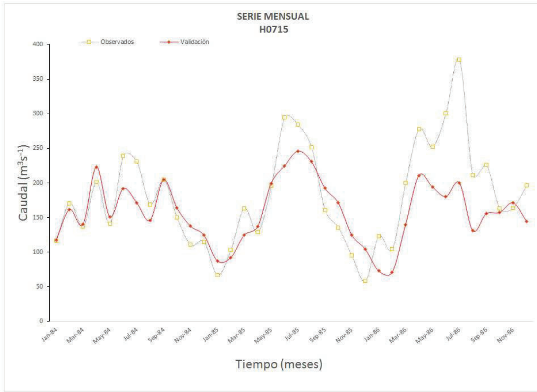
FIGURA 4.7: Hidrograma observado vs. simulado durante etapa de validación en estación H0715 ELABORADO POR: Autor
