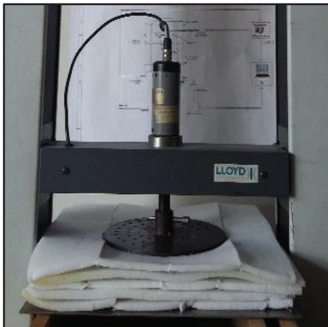
**Figura 2.2.** Ensayo de dureza a la compresión de la muestra compuesta por tiras de REP apiladas
