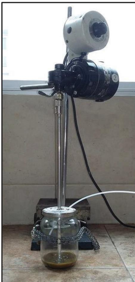
**Figura 2.4.** Sistema de reacción para el proceso de polimerización del material de poliuretano
