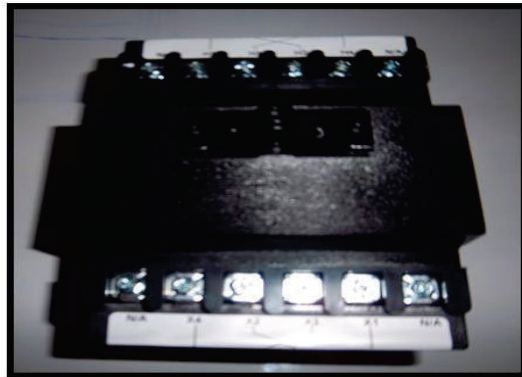
Figura 2.18: Transformador de Voltaje
