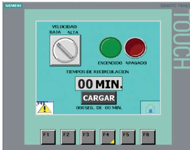
Figura 3.33: Control de recirculación
