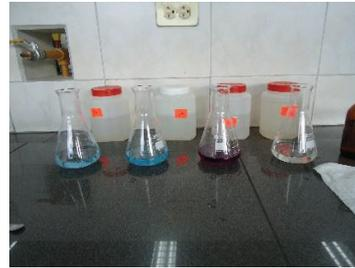
Medición de Dureza Total
