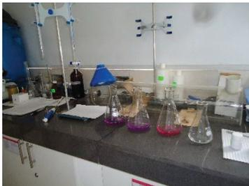
Medición de Dureza Cálcica
