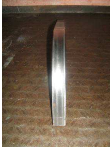
Figura 4.13 Superficie externa tubo cuadrado de 0.9mm de espesor de 25mm
