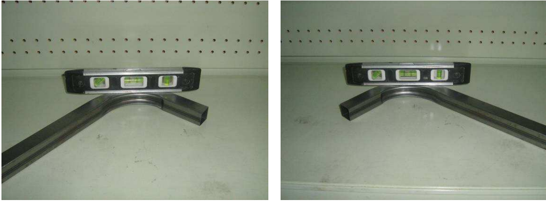
Figura 4.11 Tubo cuadrado de 0.9mm de espesor de 25mm (1pulg)
