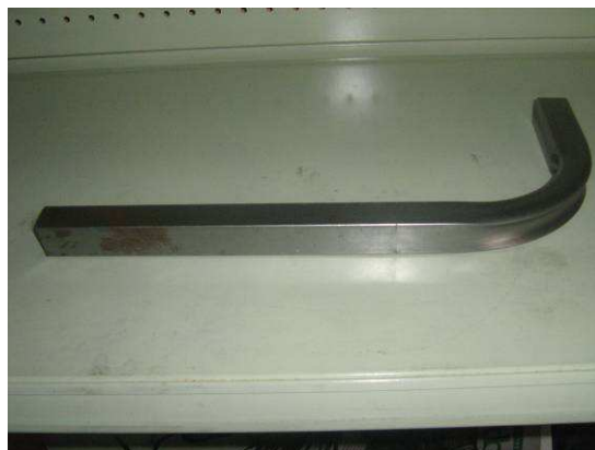
Figura 4.10 Tubo cuadrado de 20mm espesor 0.9mm doblado
