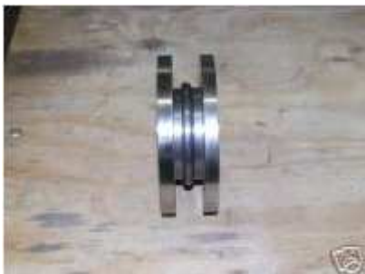
Figura 3.13 Matriz para doblar tubo cuadrado de \frac{3}{4} realizada en torno CNC
