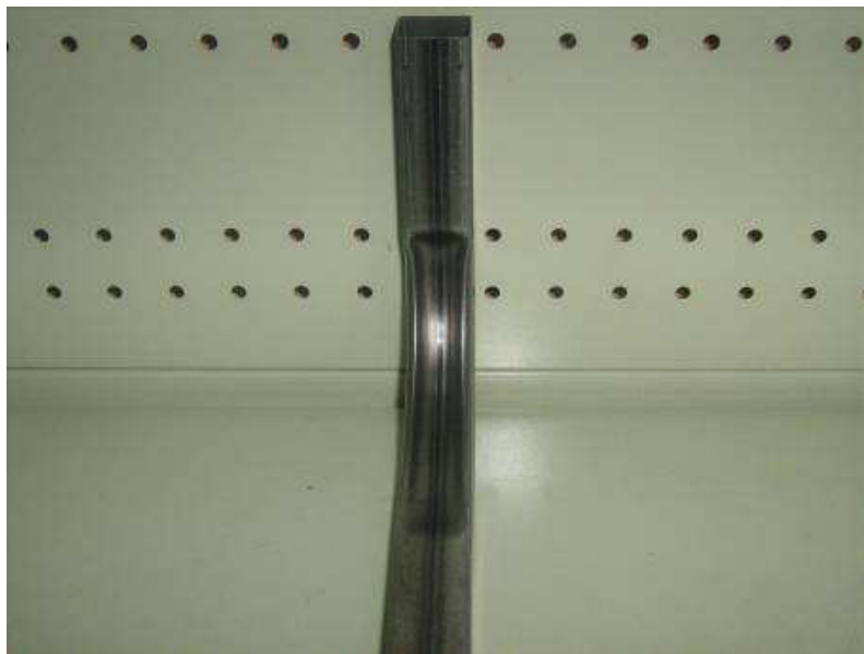
Figura 4.12 Superficie interna del tubo cuadrado de 0.9mm de espesor de 25mm
