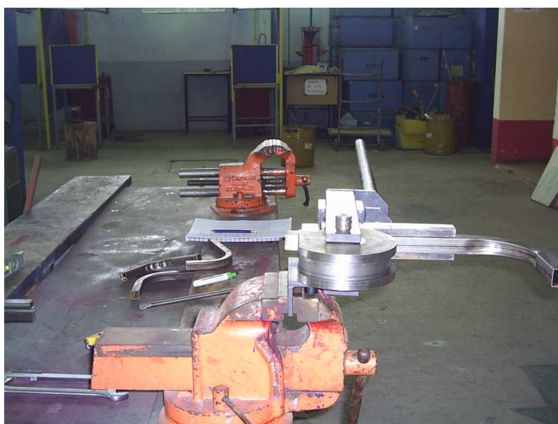
Figura 3.20 Montaje de la máquina con la matriz de 25.4mm
