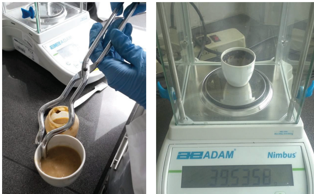
FIGURA A. 4. ENSAYO DE SÓLIDOS TOTALES, FIJOS Y VOLÁTILES
