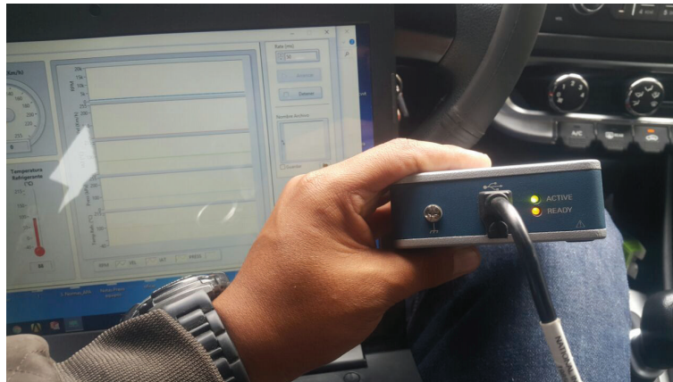
Figura 2.21 Testigos de la tarjeta de adquisición iluminados indicando comunicación con la computadora a bordo del automóvil. (Fuente: Autores)
