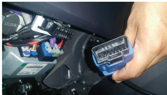
Figura 2.20 Ubicación del conector de diagnóstico del vehículo. (Fuente: Autores)
