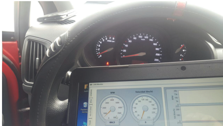
Figura 2.23 Comparativa de RPM entre el software de adquisición y el tacómetro del vehículo. (Fuente: Autores)
