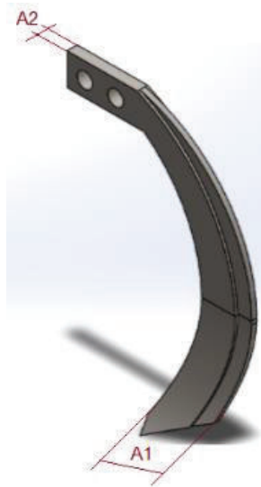
Figura 4 Modelado de cuchilla del rotavator
