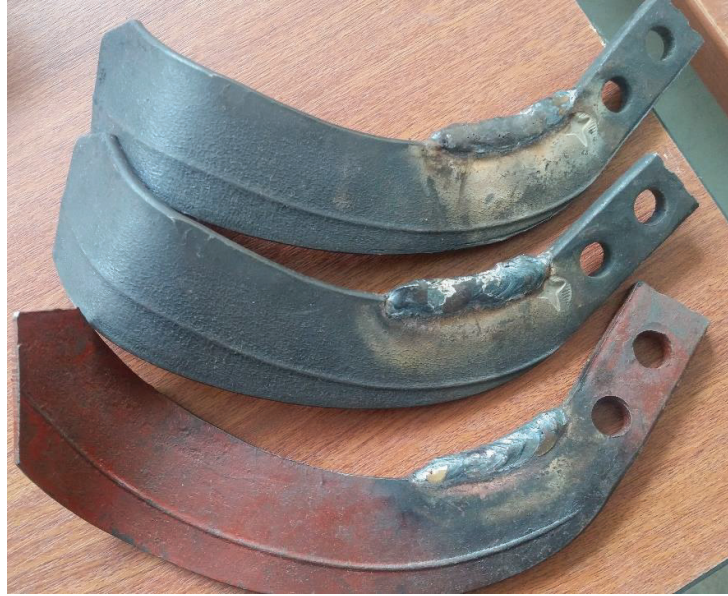
Figura 11. Cuchillas añadidas material A36 por soldadura
