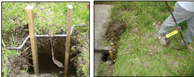
Figura 2 Obtención de la fuerza de rotura del suelo
