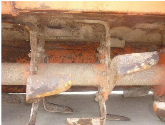
Figura 10. Cuchillas de motocultor desgastadas
