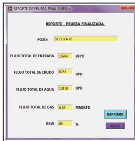
Fig. 11 Reporte final- prueba de funcionamiento del Sistema de Control.
