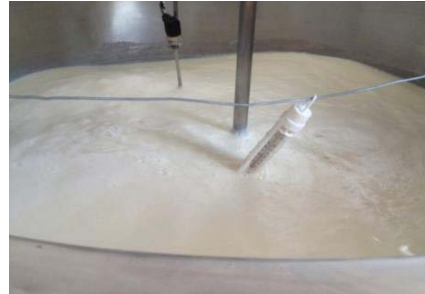
Fig. 4.1: Medición de la temperatura.
