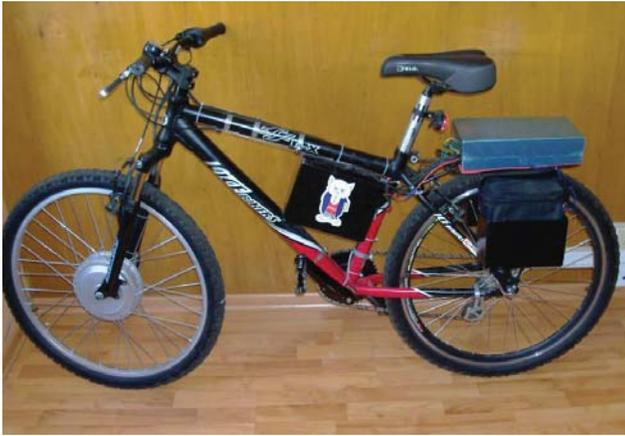
Fig. 23 Prototipo de la bicicleta asistida con regeneración de energía terminado
