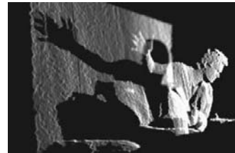
Figura 3 Imagen de profundidad procesada para representarla en una perspectiva lateral, lo cual enfatiza su carácter tridimensional, tomado de [31]
