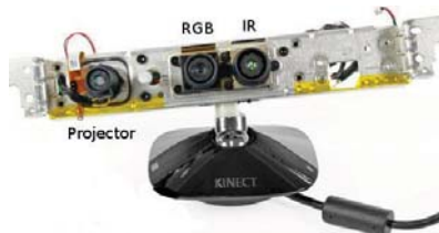
Figura 2 Distribución de los elementos del KINECT, tomado de [25]
