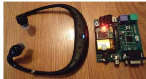
Fig.4. Tarjeta Demo Propeller y Audífonos Bluetooth
