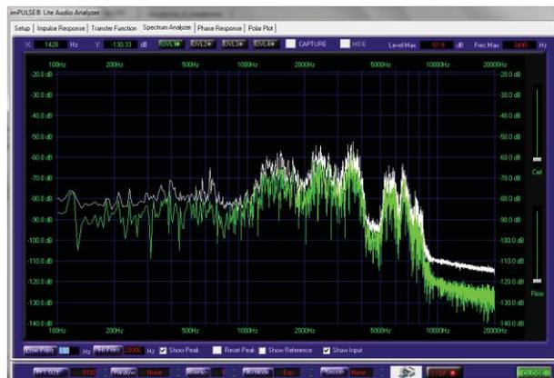
Fig.25. Filtro rechaza banda 4 y 5 KHz.
