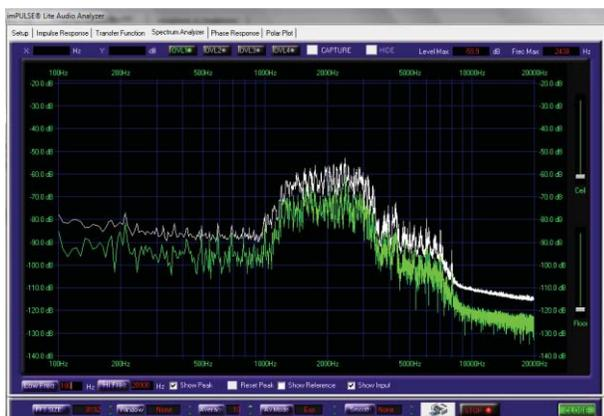
Fig.23. Filtro pasa banda 1 y 3 KHz
