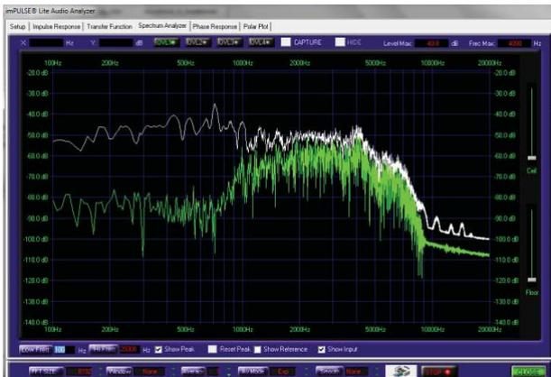
Fig. 18. Analizador de Espectro de la señal de Ruido Blanco
