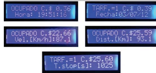
Fig. 10: pantallas en el estado ocupado
