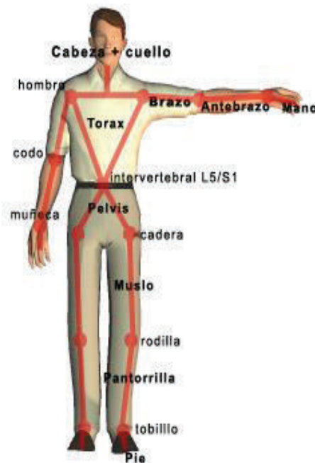
Figura 1.14 Modelo biomecánico del cuerpo humano representados como palancas. (Fuente: (Vila Giraut, 2010))
