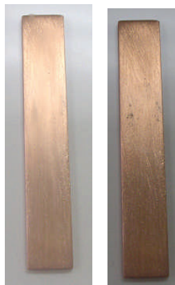
Figura 4.4 Resultados a la corrosión del diésel y aceite vegetal.
