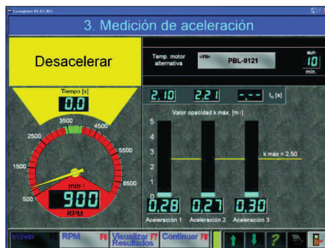
Figura 3.15 Medición de opacidad con el software Eurosystem
