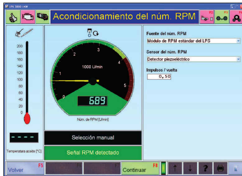
Figura 3.9 Acondicionamiento de las revoluciones del motor
