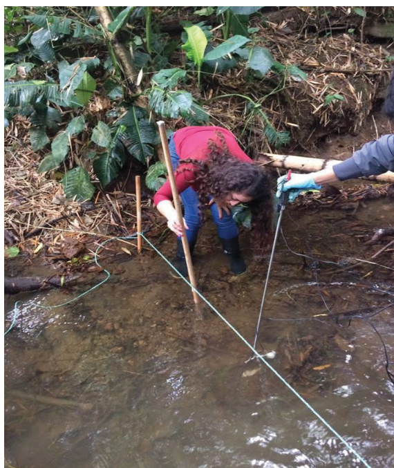
FOTOGRAFÍA 7.10 MEDICIÓN DEL CAUDAL (PUNTO INICIAL RÍO CONEJO)
