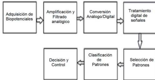
Fig. 1. Estructura básica de un sistema ICC.
