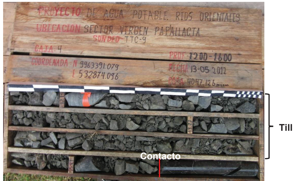
Figura 3.16: Depósito de till en contacto erosional a los 15.60 m de profundidad con una brecha polimíctica.
