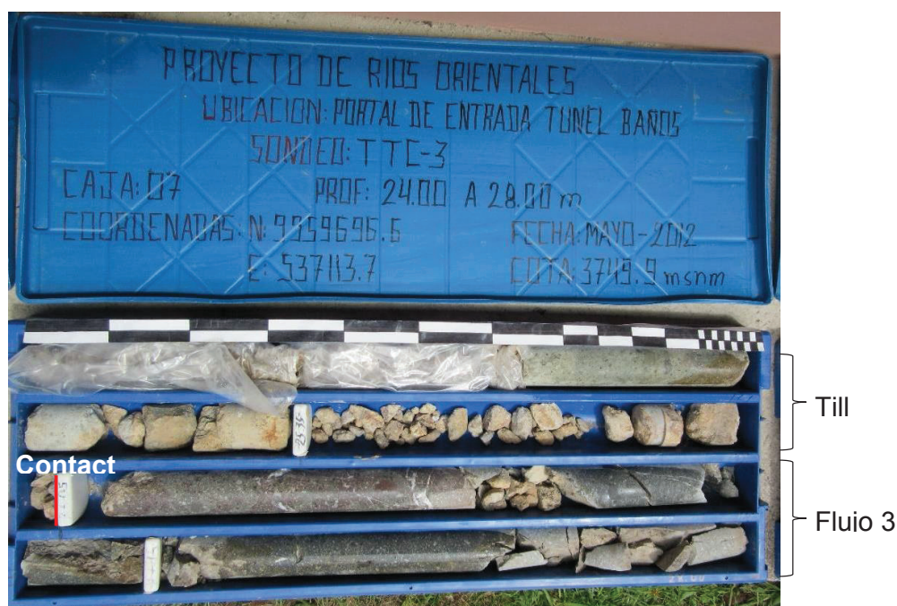
Figura 3.9: Testigos de perforación de 24.00-28.00 m, a 26.10 m se encuentra el contacto entre el till y el flujo de lava dacítico (Flujo 3).
