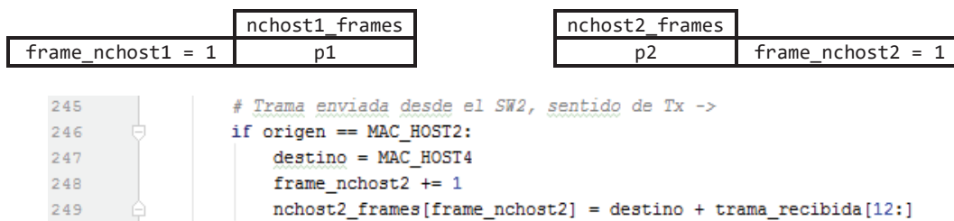
Figura 2.36 Verificación de origen de trama p2 y estado de variables
