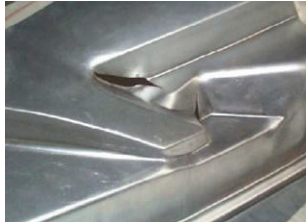
Figura 1. 22. Grietas originadas por una embutición grande
