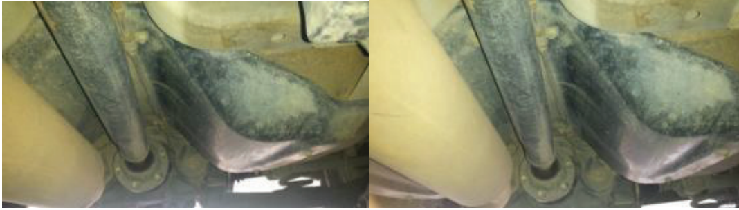
Figura 3. 4. Ubicación de protector metálico de tanque de gasolina del Grand Vitara
