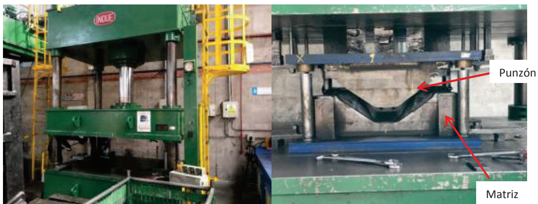
Figura 4. 29. Prensa hidráulica y herramientas utilizadas en el proceso
