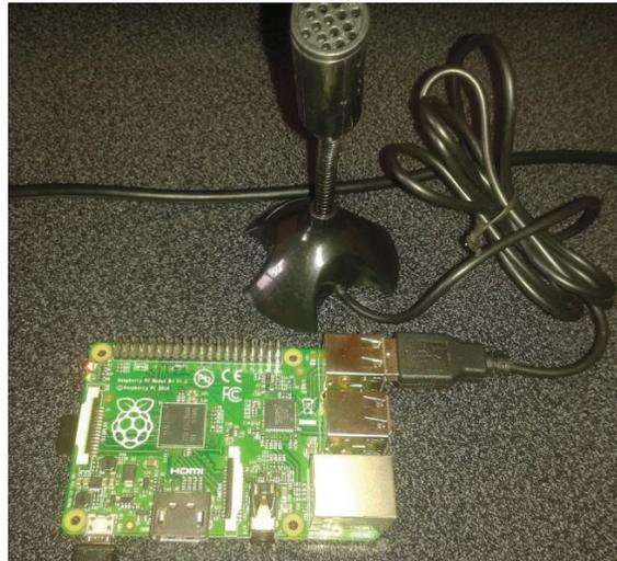
**Figura 2.25** Conexión del Micrófono USB
