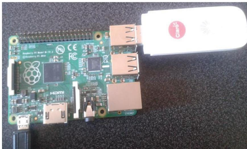
**Figura 2.26** Conexión del modem 3G
