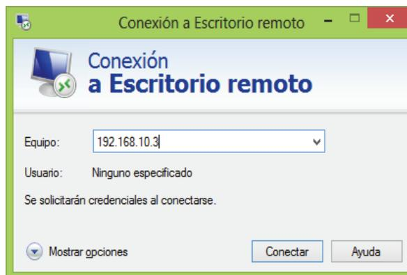
**Figura 2.21** Conexión a la Raspberry Pi mediante escritorio remoto
